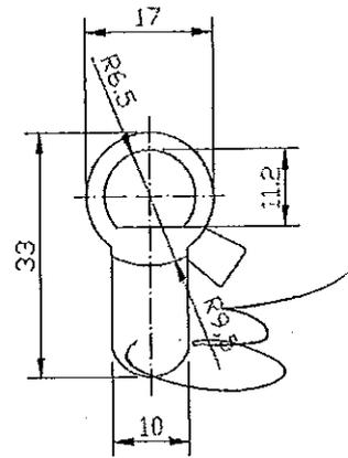
Фигура 1 - Конструкция и размери на галванизирани стоманен ключ
